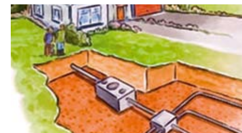
O fosă septică însoțită de un sistem de răspîndire a îngrășămîntului pe cîmp
