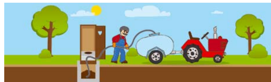
Curățarea toaletei cu aerisire îmbunătățită cu ajutorul unei autospeciale
