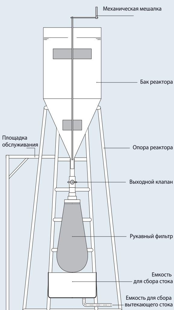
**Рисунок 7:** Схема реактора для производства струвита, оснащенного механической мешалкой и рукаундным фильтром
