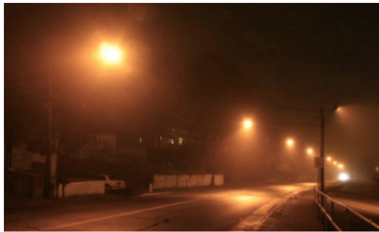
Figura 21.3. Iluminat stradal cu utilizarea lămpilor eficiente cu vapori de sodiu de înaltă presiune (sursa, city-data.com). Observați culoarea portocalie a acestora.
