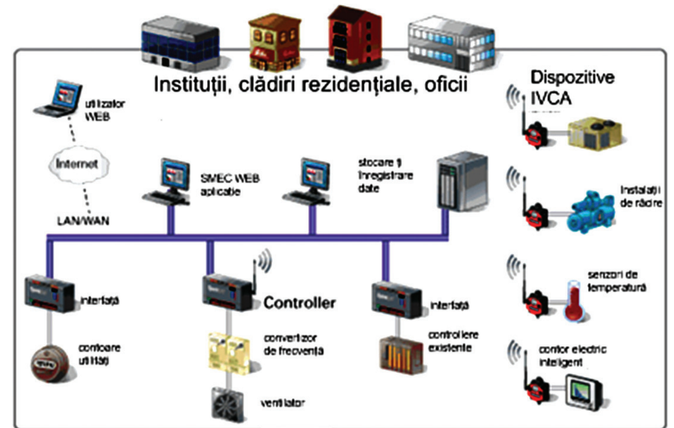
Figura 12.2. Componentele și funcțiile sistemului de management al energiei în clădiri - SMEC (sursa: www.poweritsolutions.com).
