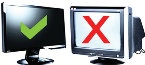
Figura 10.8. Monitoarele moderne pentru computere consumă mult mai puțină energie decât cele cu tub catodic. În prezent, ecranele LCD sunt cele mai eficiente și oferă imaginea de cea mai bună calitate (sursa: http://trichandrapamungkas94.wordpress.com/2011/07/22/perkembangan-alat-visualisasi-monitor ).
