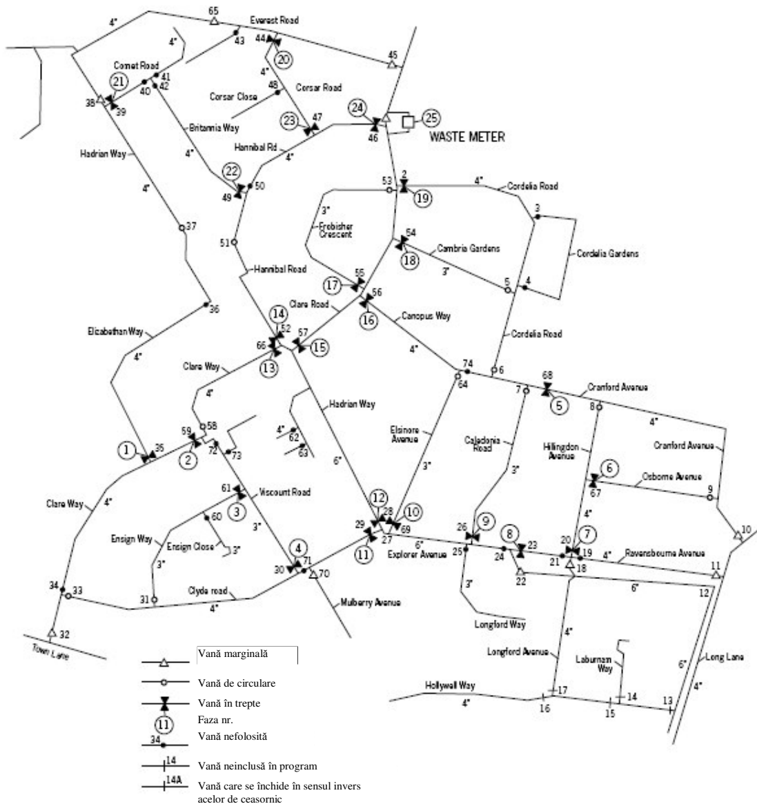
Figura 8- 6: Planul unei zone obisnuite supuse testarii in trepte (Reprodus din Raportul 26 WAA/WRC)
